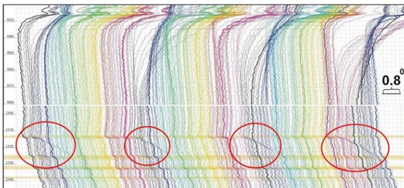
Рис. 4. Работа пластов водой при остановке ЭЦН
