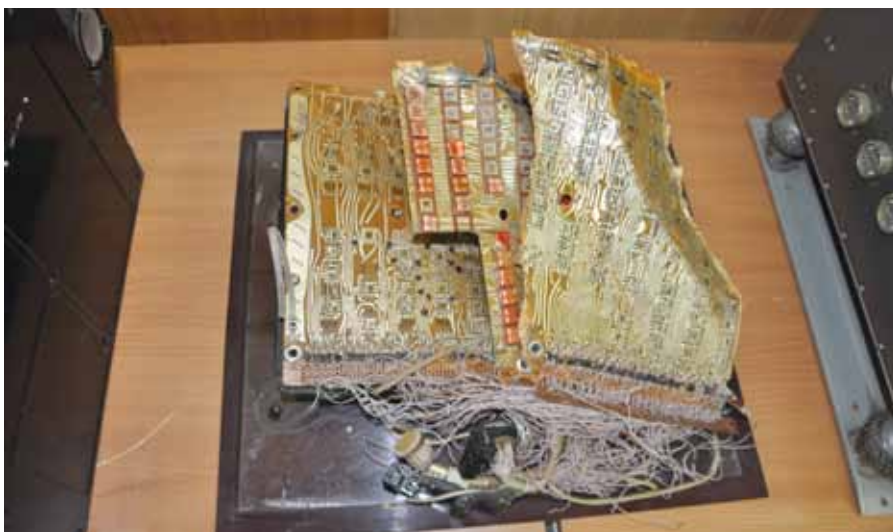
Экземпляр БЦВМ «Аргон-11С», побывавший в космосе и облетевший Луну. Особенности сохранности объясняются не столько жесткой посадкой космического аппарата на Землю, сколько неизменным стремлением высоких гостей НИИ «Аргон» увезти на родину фрагмент исторического аппарата.
