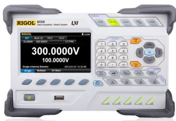
**M301** – система сбора данных/коммутации с модульной структурой. Представляет собой комбинацию многофункционального прецизионного мультиметра и многоканального коммутатора. Мультиметр позволяет проводить измерения напряжения и силы постоянного и переменного тока, электрического сопротивления, а коммутатор – переключать каналы и регистрировать измерительные сигналы.
